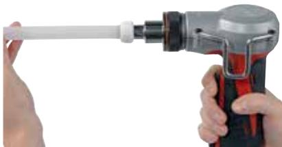
2 - Élargissez l'extrémité du tube à froid, à l'aide de la tête d'expansion
