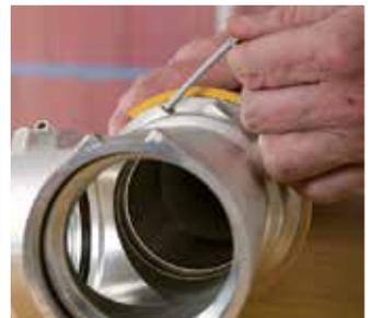
4 - Verrouiller l'assemblage à l'aide de la tige de verrouillage Riser correspondante
