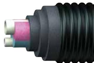
**Uponor Quattro** - Tubería preaislada con 4 tuberías, máx. 6 bar/95 °C, calefacción y/o máx. 10 bar/ 95 °C Agua caliente sanitaria
