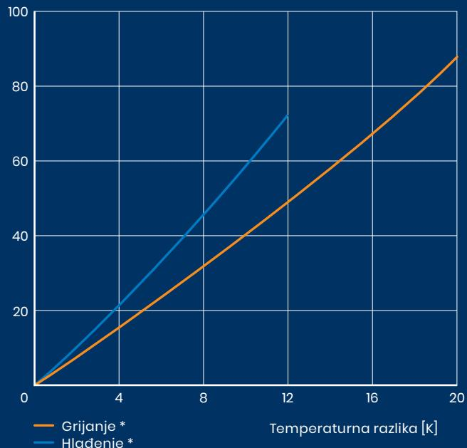
\* Kapacitet grijanja i hlađenja sustava Uponor Thermatop S s gipsanim pločama od 10 mm (0,25 W/mK)
