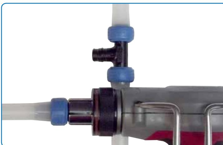
Per mezzo dell'espansore Uponor la tubazione viene espansa per poterli infilare il portagomma del raccordo.
