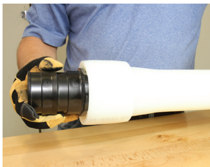
Figure 3-18 : Insérer le raccord
