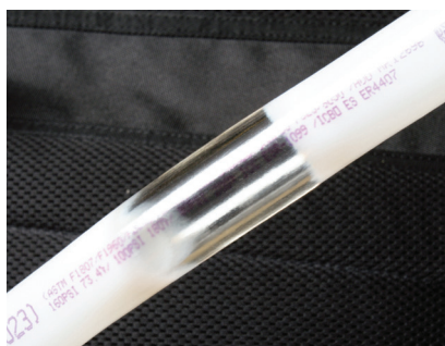
Figure C-1 : Reformer un tuyau déformé
