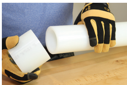
Figure 3-14 : Ajouter la bague
