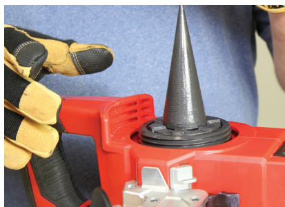
Figure 3-9 : Installation de la tête de dilatation FORCE LOGIC
