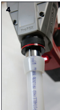
Figure 3-8 : Dilatation avec l'outil ProPEX Milwaukee M18
