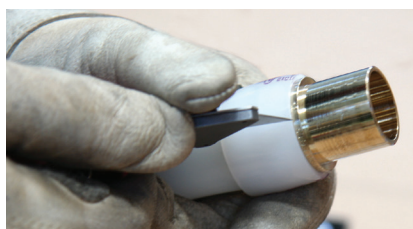
Figure 3-22 : Couper la bague
