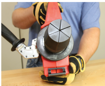
Figure 3-12 : Alignement correct de la tête de dilatation
