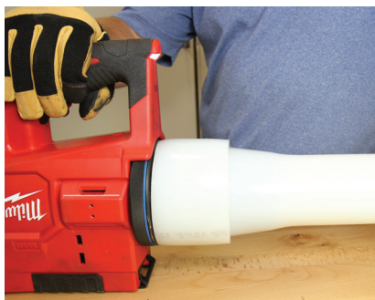
Figure 3-17 : Dilater jusqu'à la butée
