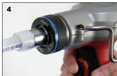
Figure 3-3 : Dilatation avec les outils ProPEX Milwaukee M12, M12 FUEL, M18 et M18 FUEL de 2"
