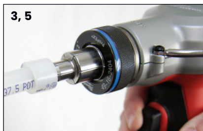
Figure 3-3 : Dilatation avec les outils ProPEX Milwaukee M12, M12 FUEL, M18 et M18 FUEL de 2"
