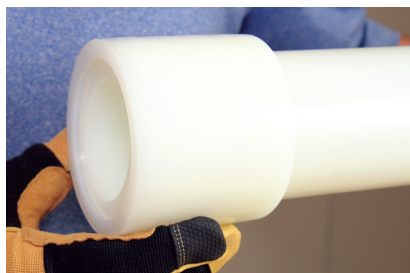
Figure 3-15 : S'assurer que la bague repose sur la butée
