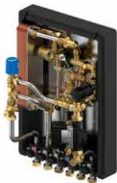
Combi Ports sind Wohnungsstationen für Mehrfamilienhäuser mit dezentraler Brauchwassererwärmung und eingebauten Sekundärheizkreisen für verschiedene Anwendungen, wie z.B. Radiatorheizungen, Flächenheizungen und Kühlsysteme.
