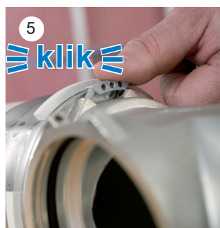
Kuva 1. Asenna viistetty komposiittiputki Uponor RS-liitinjärjestelmän puristuspäähän.
