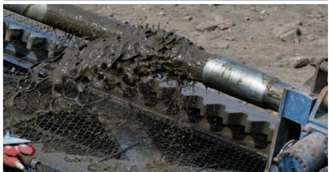
Fot. 8. Moment rozkręcania żerdzi płuczkowych 6 5/8”.
