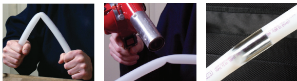
Figure 43: Reformar tubería torcida
