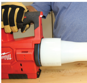
Figura 18: Expandir hasta alcanzar el hombro
