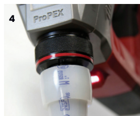
Figura 9: Expansión con la herramienta expansora ProPEX M18 de Milwaukee
