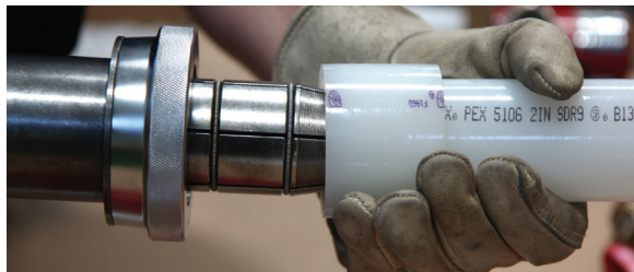
Figura 22: Deslizar el cabezal en la tubería
