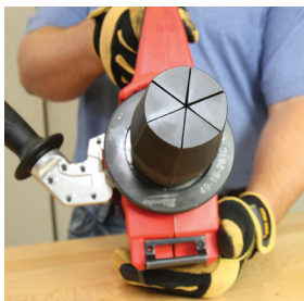
Figura 13: Alineación correcta del cabezal de expansión
