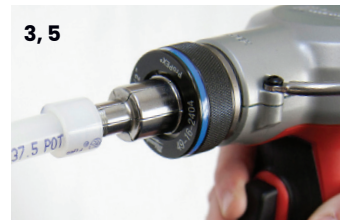
Figura 2-4: Expansión con las herramientas expansoras ProPEX M12, M12 FUEL, M18, y M18 FUEL de 2" de Milwaukee
