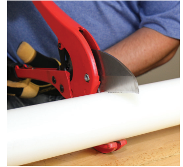
Figura 2-14: Cortar la tubería
