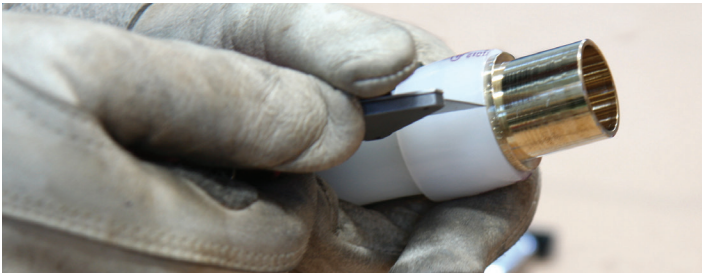
Figura 2-33: Cortar el anillo
