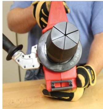
Figura 2-13: Alineación correcta del cabezal de expansión
