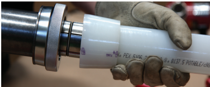
Figura 2-24: Girar el cabezal
