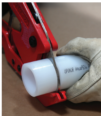
Figura 2-20: Cortar la tubería
