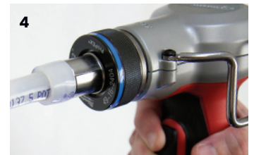
Figura 2-4: Expansión con las herramientas expansoras ProPEX M12, M12 FUEL, M18, y M18 FUEL de 2" de Milwaukee
