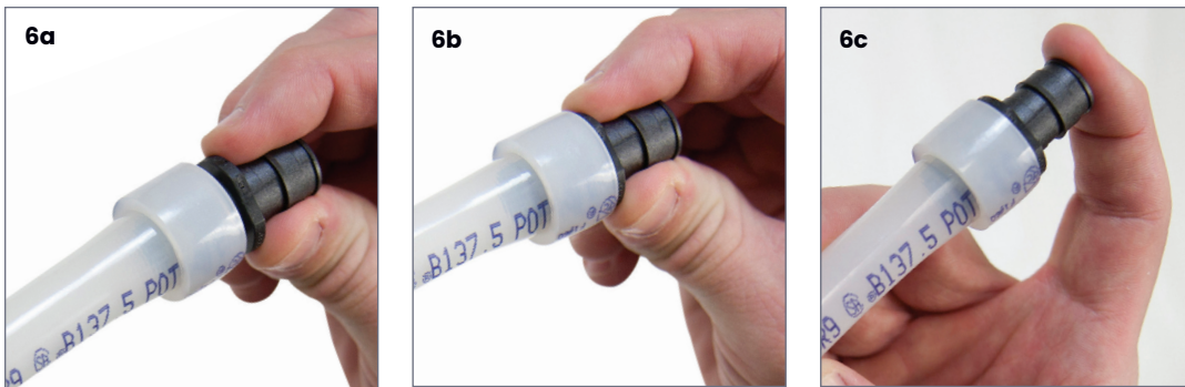
Figura 2-5: Introducción del accesorio ProPEX en la tubería PEX de Uponor de 1/2"
