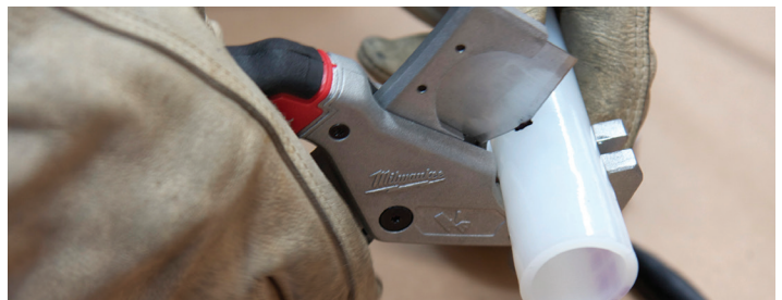
Figura 2-39: Cortar la tubería en la posición indicada
