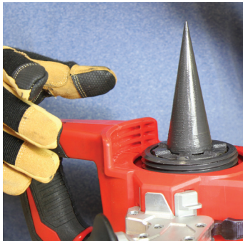
Figura 2-10: Instalación del cabezal de expansión FORCE LOGIC
