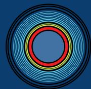
Для достижения тех же характеристик теплопотерь, что и с применением панелей VIP, требуется более чем вдвое больший наружный диаметр.
