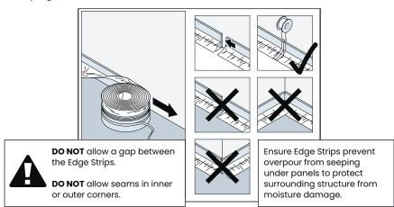
Figure 4: Install edge strips
