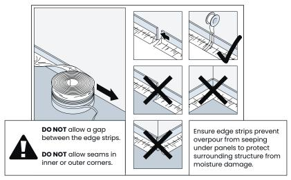
Figure 12: Install Edge Strips
