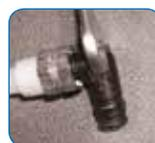
O esforço máximo de torção para 1/2", 3/4" e 1" é de 15 Nm.
