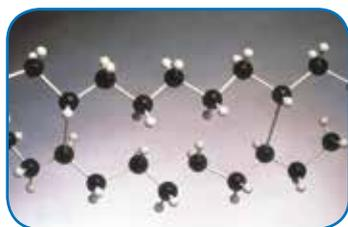
Esta nova estrutura torna impossível fundir ou dissolver o polímero sem destruir previamente a sua estrutura. É possível avaliar o nível alcançado de ligação transversal medindo o grau de reticulação.
