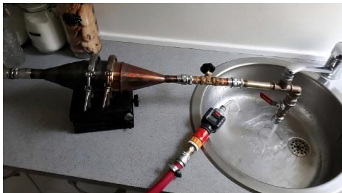
Rys. 1. Pobieranie próbek wody z kranu. Umieszczenie kolumny próbującej ze stali nierdzewnej w kranie wody pitnej w celu pobrania próbek wody o objętości 50 l
