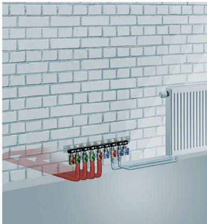
Le rail de connexion avec robinets à boisseau sphérique sont placés sur le mur.
