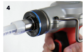
Figure 2-4 : Dilatation avec les outils ProPEX Milwaukee M12, M12 FUEL, M18 et M18 FUEL de 2"
