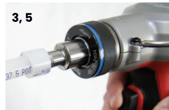
Figure 2-4 : Dilatation avec les outils ProPEX Milwaukee M12, M12 FUEL, M18 et M18 FUEL de 2"
