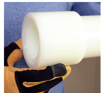
Figure 2-16 : S'assurer que la bague repose sur la butée
