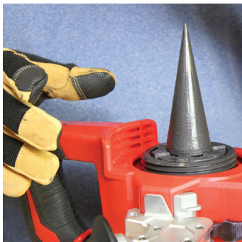
Figure 2-10 : Installation de la tête de dilatation FORCE LOGIC
