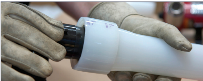
Figure 2-26 : Insérer le raccord
