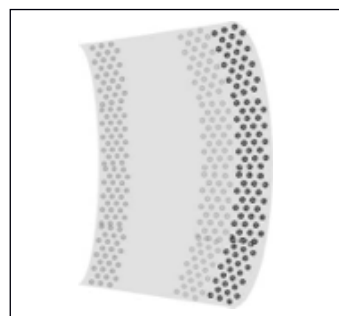
Figure 1-2 : PEX-b (silane) réticulé à 65-70 %
