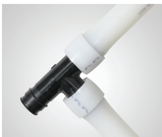
Figure 1-6 : Début du test avec un té ProPEX en EP de 2"
