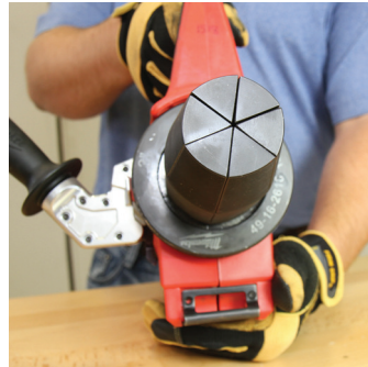
Figure 2-13 : Alignement correct de la tête de dilatation
