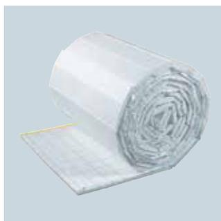
*Il pannello Uponor Klett. Nella versione rotolo per il fissaggio della tubazione con isolamento termico ed isolamento acustico in base alle norme DIN EN 13163 e DIN 4108-10, realizzato in EPS con foglio in tessuto incollato in fabbrica per la posa in sovrapposizione. Disponibile nelle versioni Standard 20, 27, 44, 53 e Grafite 20, 23, 38, 47 mm.*
