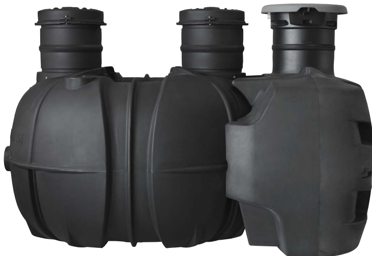
Uponor Clean II -panospuhdistamo on mitoitettu kahden perheen tai 3–12 asukkaan kaikille asumajätevesille, maksimivirtaama 2 100 l/vrk.
