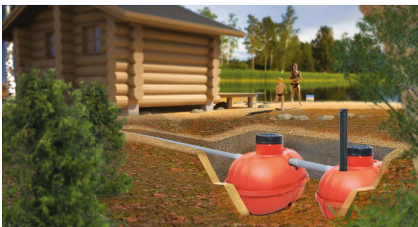
Saunasta pesuvedet johdetaan saunakaivoon ja kaivosta maaperään puhdistumaan. Mökkikaivo erottelee astianpesuvesistä kiinteät aineet sekä rasvan. Selkeytynyt vesi johdetaan eteenpäin saunakaivoon imeytettäväksi.
