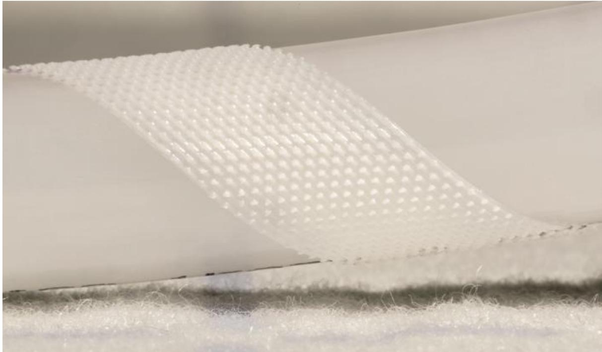
Il sistema è composto dal pannello di posa in polipropilene (spessore 3 mm) accoppiato a foglio in TNT (tessuto-non-tessuto) e dal tubo Comfort Pipe PLUS (PE-Xa con barriera EVOH) o Uponor MLCP RED (Multistrato PE-RT/alluminio/PE-RT) avvolto da uno strip con micro-uncini: **l'auto-fissaggio della tubazione avviene tramite una leggera pressione e risulta semplice, rapido, senza vincoli, riposizionabile.**
