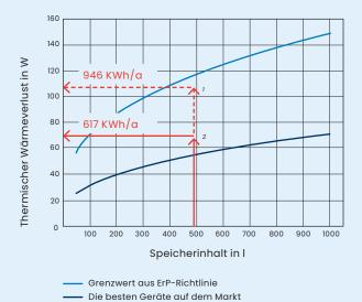
Die Grafik zeigt den jährlichen Wärmeverlust, im Vergleich bei einem durchschnittlich gedämmten¹ und einem sehr gut gedämmten² Trinkwasserspeicher.
