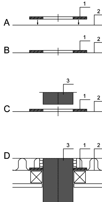
1 = Tiivistyslaippa 2 = Höyrysulku 3 = Valmiiksi eristetty kanava
