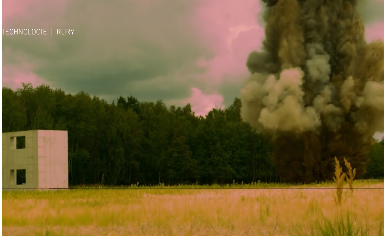
Ryc. 5. Detonacja ładunku w odległości 2 m od schronu DN 3000 z rury Weholite, fot. Pelter
