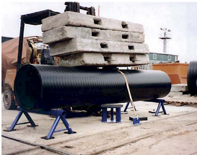
Испытание продольной жесткости трубы DN/ID 600 мм, SN4. Нагрузка 29 кН, деформация в продольном направлении 30 мм, деформация в кольцевом направлении 54 мм.
