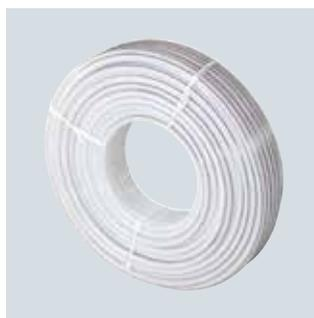
*Il tubo Uponor Comfort Pipe PLUS - PE-Xa con barriera di diffusione dell'ossigeno realizzata in EVOH e uno strato protettivo esterno aggiuntivo. Di colore bianco con due strisce blu. È conforme alla norma DIN EN: ISO 15875 "Tubazioni in plastica impianti di acqua calda e di acqua fredda, con polietilene reticolato", a tenuta di ossigeno nel rispetto della norma DIN 4726.*
