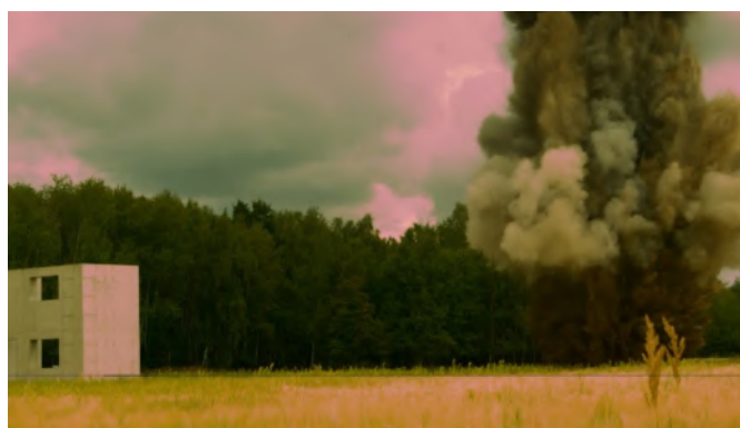
Rys. 4. Detonacja ładunku w odległości 2 m od schronu DN3000 z rury PE Weholite (fot. Pelter)
