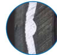
Tubería soldada a tope/testa
