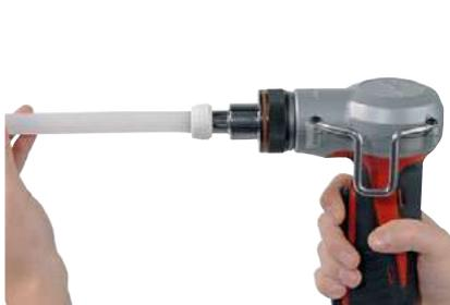
2 - Élargissez l'extrémité du tube à froid, à l'aide de la tête d'expansion
