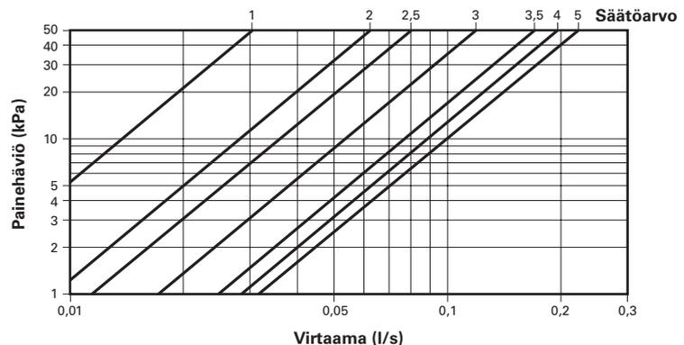
**Ohitusputken virtauksen säätäminen**
