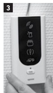
Infopanelen kan tas bort från vägg-hållaren genom att trycka t ex på ovan-sidan med spetsen av en skruvmejsel.
