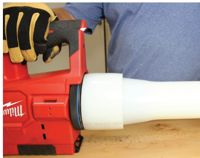
Figura 3-17: Expandir hasta alcanzar el hombro
