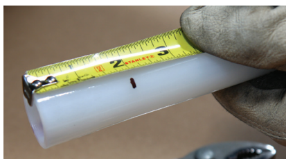
Figura 3-27: Medir desde el extremo del tubo
