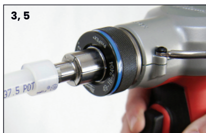
Figura 3-3: Expansión con las herramientas expansoras ProPEX M12, M12 FUEL, M18, y M18 FUEL de 2" de Milwaukee
