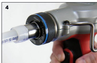
Figura 3-3: Expansión con las herramientas expansoras ProPEX M12, M12 FUEL, M18, y M18 FUEL de 2" de Milwaukee
