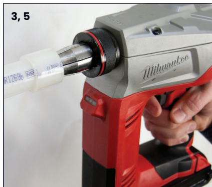
Figura 3-8: Expansión con la herramienta expansora ProPEX M18 de Milwaukee
