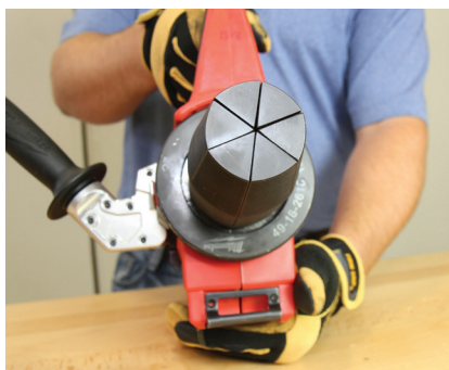
Figura 3-12: Alineación correcta del cabezal de expansión
