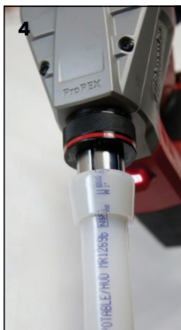
Figura 3-8: Expansión con la herramienta expansora ProPEX M18 de Milwaukee
