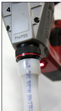
Figura 3-8: Expansión con la herramienta expansora ProPEX M18 de Milwaukee
