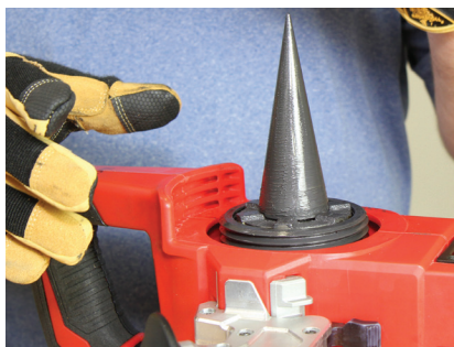
Figura 3-9: Instalación del cabezal de expansión FORCE LOGIC
