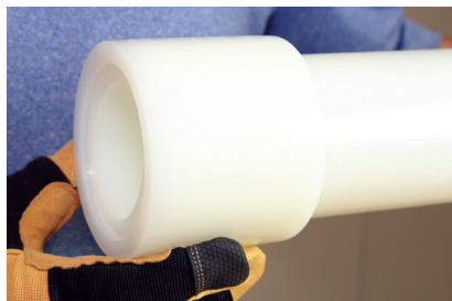
Figura 3-15: Asegurar que el anillo alcance el borde de tope
