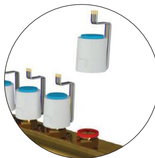
4 le testine sono dotate di un fermo interno che le rendono normalmente aperte in fase di avanzamento. Dalla prima alimentazione in poi si comporteranno come normalmente chiuse.
