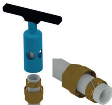
Figura 3 Calibrare e sbavare la tubazione
