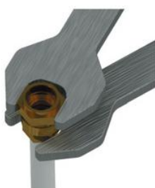
Figura 5 Stringere il dado con l'ausilio di chiavi fisse
