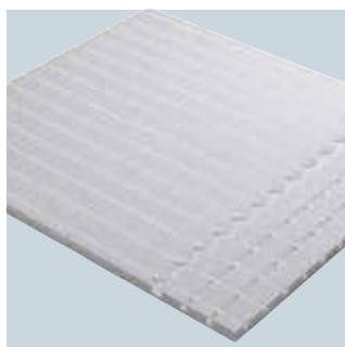
Uponor Siccus Verlegeplatte – Verlegeplatte aus EPS mit Rohrleitungskanälen zur Aufnahme der Uponor Siccus Wärmeleitlamellen. Verlegeabstände 15/22,5/30 cm.
