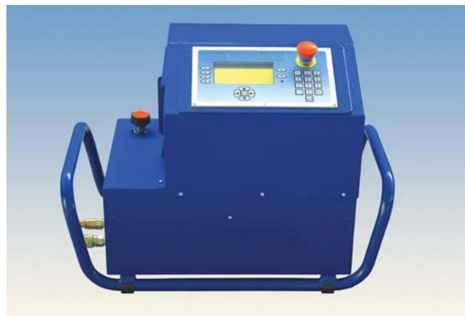
После того как торцеватель вручную установлен на место, процесс торцовки будет продолжаться автоматически. После завершения подготовительных мер (включая торцовку, проверку соосности, очистку, проверку образования грата, удаление нагревательного зеркала) запустится автоматизированный цикл сварки. Сварщик постоянно получает информацию о прохождении процесса за счет удобного в обращении дисплея, показывающего диаграмму времени фазы сварки.
