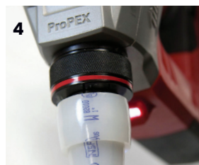
Figure 9 : Dilatation avec l'outil ProPEX Milwaukee M18
