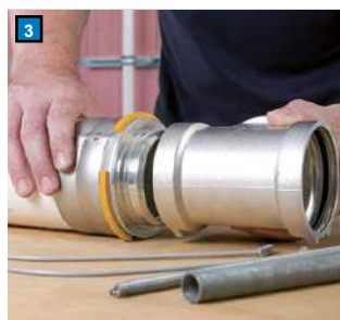
Samling Tryk den pressede samling ind i basisdelen
