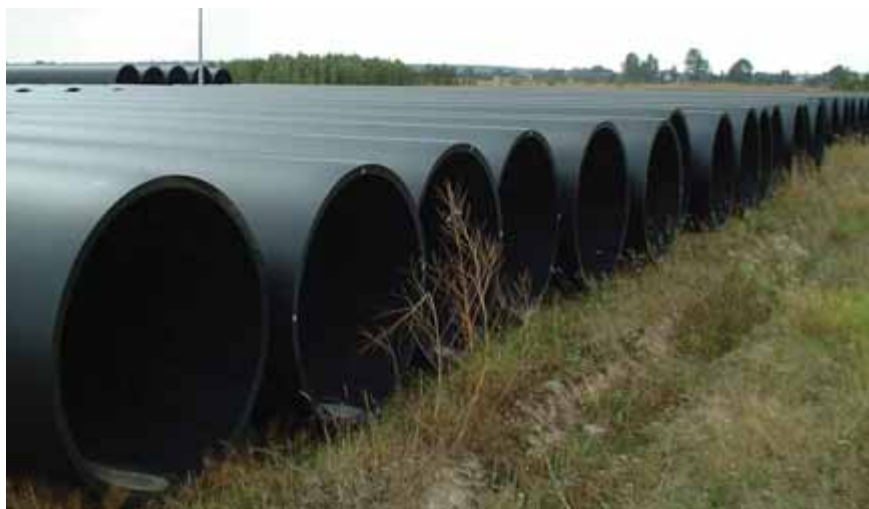
Rury PE o średnicy 1400 mm w fabryce w Kleszczowie
