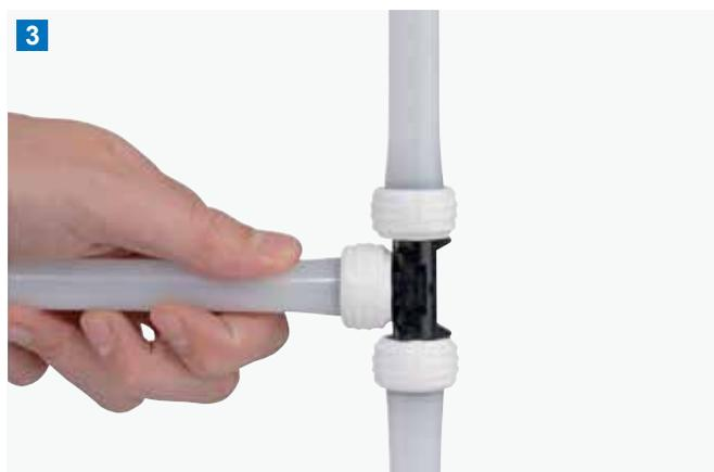
3 Dopo l'espansione inserire sul raccordo fino a battuta, premere per qualche secondo che il tubo e l'anello Q&E si restringano. Fatto!
