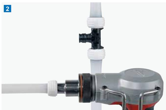
2 Espandere uniformemente il tubo e l'anello elastico Q&E completamente fino in fondo.
