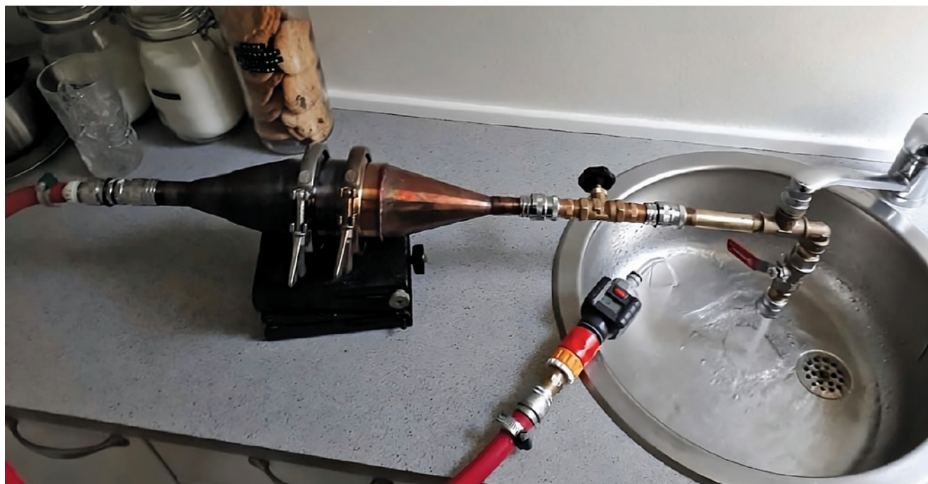
Fot. Pobieranie próbek wody z kranu. Umieszczenie kolumny próbującej ze stali nierdzewnej w kranie wody pitnej w celu pobrania próbek wody o objętości 50 l
