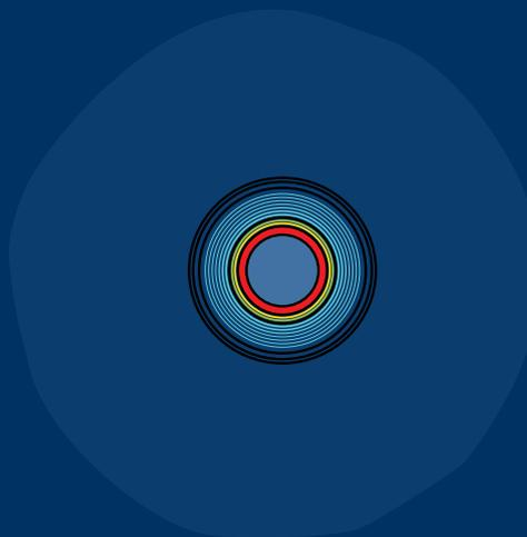
Para la misma pérdida de calor que con el aislamiento VIP, se necesita un diámetro exterior de más del doble.
