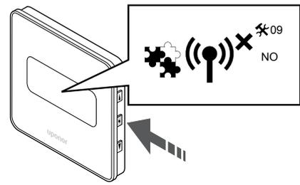
Press **OK** to enter parameter edit mode (the parameter starts flashing).
