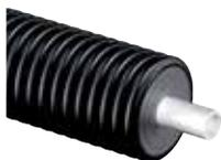
Ecoflex Single pipe PEX, max. 10 bar / 70°C DHW. **Use Wipex 10 bar coupling.**
